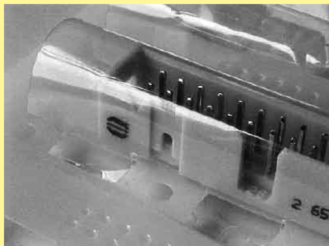
Рис. 5: Разъем компании HARTING, установленный на ленту, готовую к размещению с использованием рабочей станции для работы с нетипичной формой.
